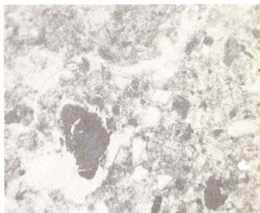
照片11·8 萍乡风化煤腐殖酸 示风化煤及较多孔隙，基质较疏散 透射光 \times 10
