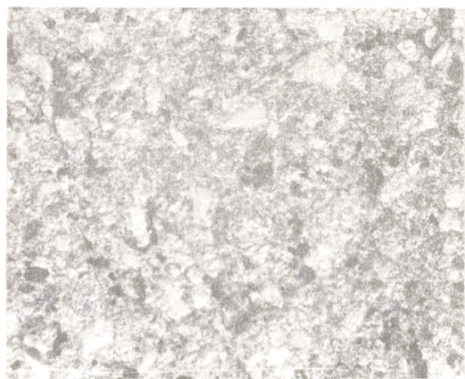
照片11·7 对照 细土物质的紧实微结构，基质较密实 透射光 \times 10
