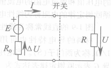
图 1-10 电路的带载通路
