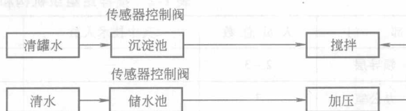
图 1-2 搅拌站水源系统图
