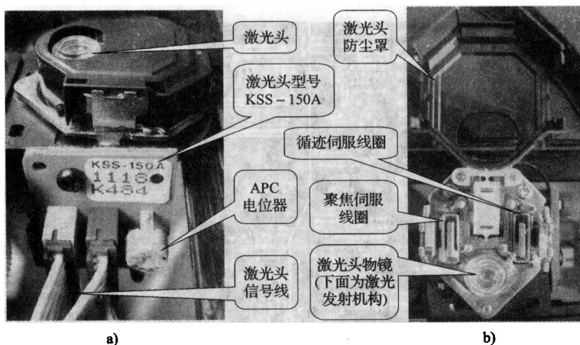
图 1—13 KSS—150A 激光头的细微结构
