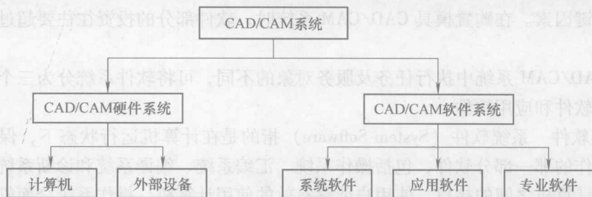
图 1-1 CAD/CAM 的系统构成
