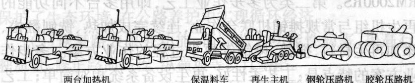
图 1.6 RM2000RS 就地热再生机组及相应施工配套设施
