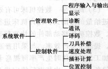
图 1-3 CNC 系统软件的组成
