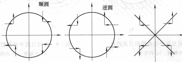
图 1-7 四个象限圆弧、直线进给方向
