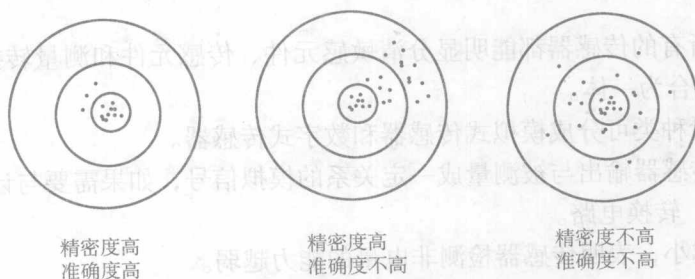
图 1-12 用射击弹点表示精度
