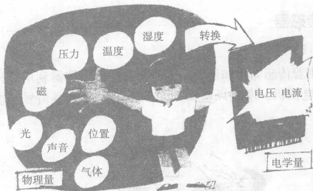
图 1-2 传感器将物理量转换为电学量
