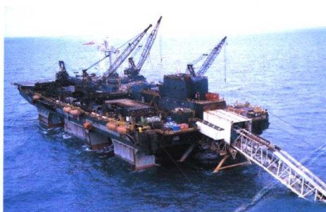
在建的350吨多用海洋工程船
