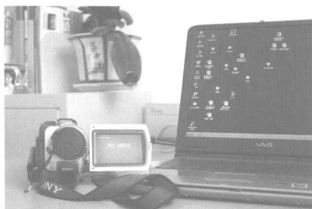
图 1-12 DV 摄像机向个人计算机传输图像
