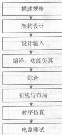
图 1-8 FPGA 设计流程
