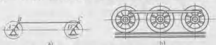
图1-10 正平行四边形机构运动简图及应用实例
