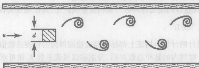
图 1-7 涡街流量计旋涡发生示意图
