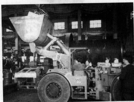
(a) 铲运机举升工况测试
