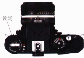
图 2-32 机械相机感光度设定
