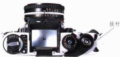
图 2-34 机械相机重复曝光装置
