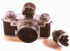
图 2-12 多焦距组合光学取景器
