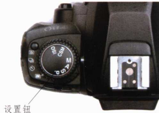
图 2-35 电子相机重复曝光装置
