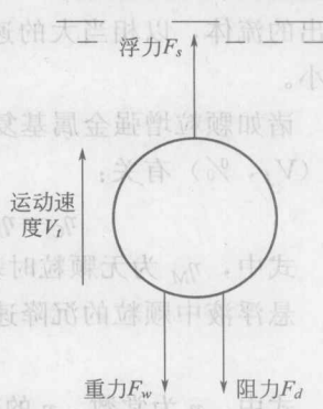
图 1-9 流体中作用于颗粒的力
