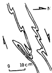
图4 平卧向斜北翼核部大理岩底板附近 小型褶皱素描指示平卧向斜倒转翼
