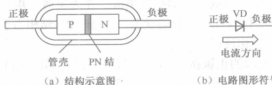
图 1.12 二极管结构与符号
