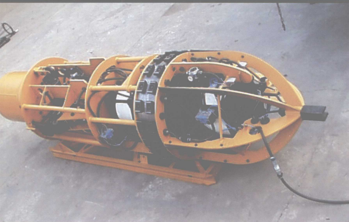
PPC3640 型管道气动内对口器
