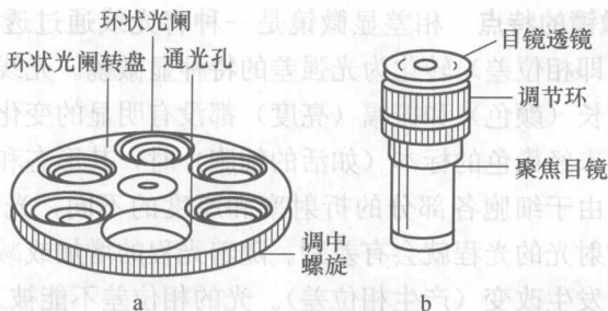
图 1-8 相差显微镜的环状光阑（a）和合轴调节望远镜（b）
