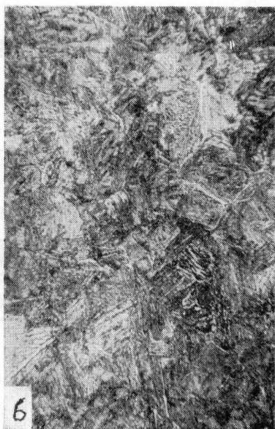
图6 400×主动齿心部 显微组织
