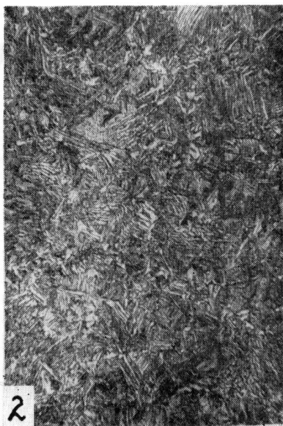
图 2 400×主动齿心部 显微组织
