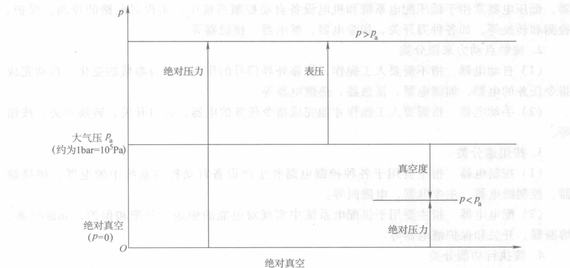
图 1-3 绝对压力、表压力和真空度关系示意图
