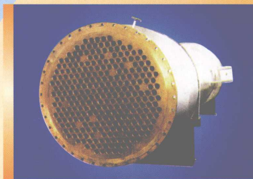
出口印度尼西亚精盐工程的I效、II效蒸发器，壳体为SUS316L，换热管为T2，管板为20g+H62复合板
