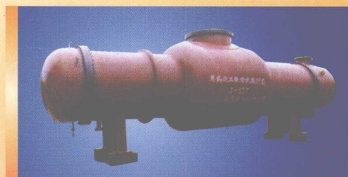
为扬子石化公司烯烃厂生产制作的EA-537六效冷凝器(Ø2100/Ø3100)×16×1950mm，63448kg/台 换热面积2715m 2 10 # 管16MnR壳体16Mn锻管板
