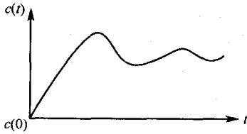
图 1.11 有自衡振荡过程的响应曲线
