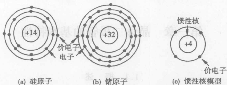
图 1.2.1 硅和锗的原子结构模型
