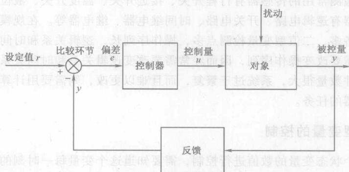
图 19-3 闭环控制系统的基本组成
