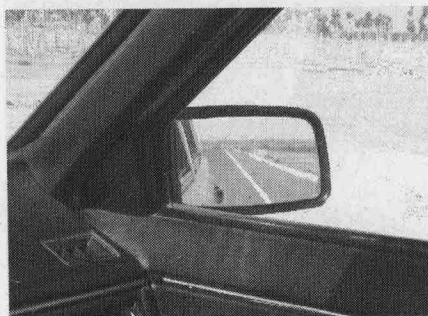
图 1.2.21 调整后，右后视镜看到的影像、各部分的比例与左后视镜中的类似
