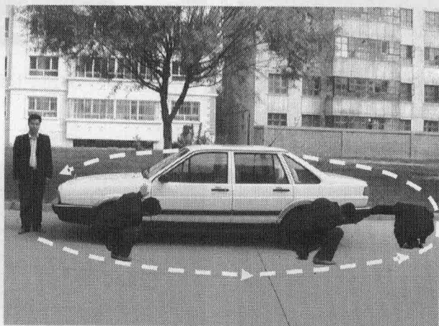
图 1.2.4 围车绕行一周进行安全检视，检查周围有无障碍物、行人、轮胎花纹间有无异物、轮胎气压等
