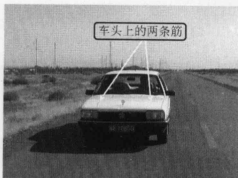
图 1.1.1 车头上有两条筋，俗称边筋
