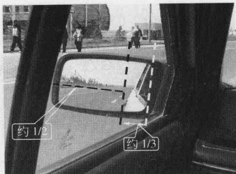
图 1.2.19 在水平方向上，车体在后视镜中约占 1/3，在垂直方向上，路面和天空在后视镜中大约各占 1/2
