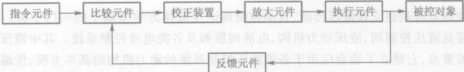
图 1.6 液压控制系统职能结构图
