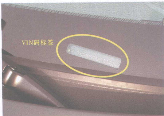
图 1-4 车前风窗玻璃处的 VIN 码标记
