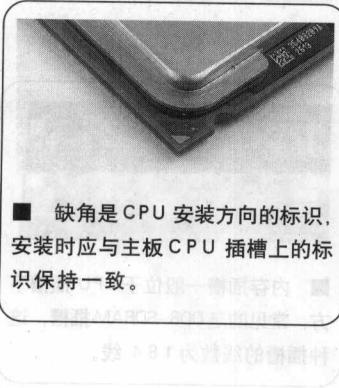
■ 缺角是 CPU 安装方向的标识，安装时应与主板 CPU 插槽上的标识保持一致。
