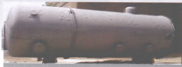
38000型空分設備配套的水冷塔
