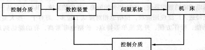
图1-1 数控机床的结构组成
