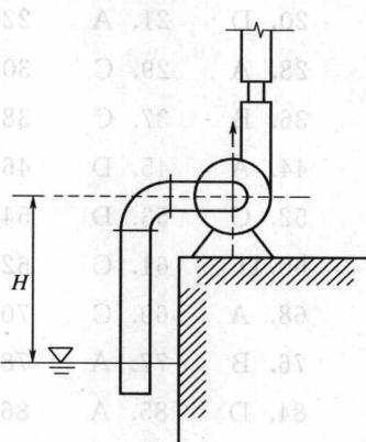
A. 泵的安装位置高出吸液面的高差过大
