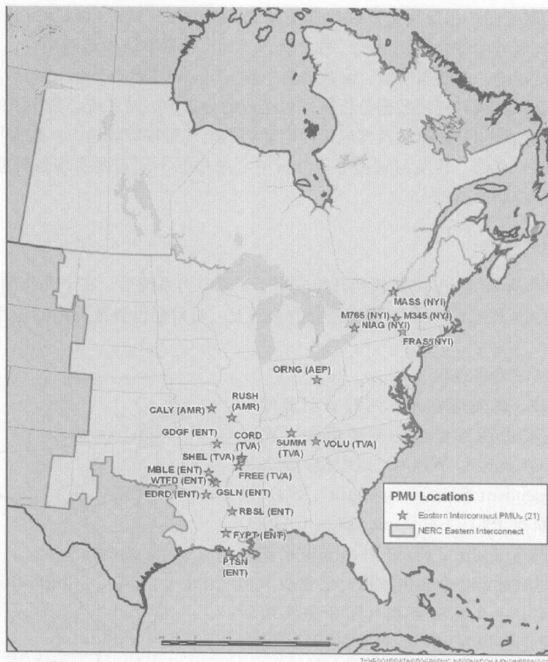
图 4 美国东部地区 PMU 配置示意图 (EIPP)
