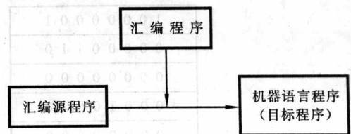
图 1.1 汇编程序与汇编源程序、目标程序的关系
