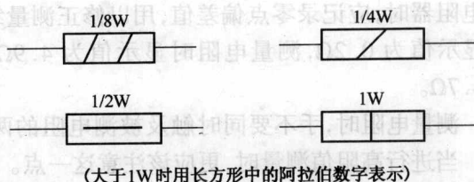
图 1-3 电阻功率表示方法
