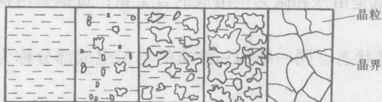
图 1-5 纯金属的结晶过程
