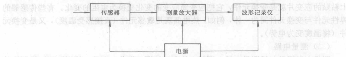
图 1-2 模拟测量系统框图
