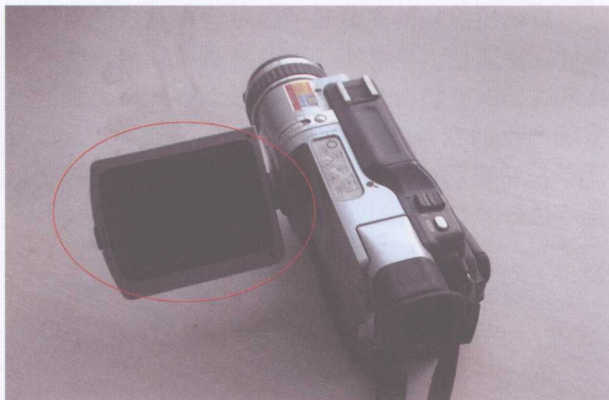
▲ 数码 DV 与专业的摄像机的区别之一就是 LCD 显示屏。一般的专业摄像机只有取景器而没有 LCD 显示屏
