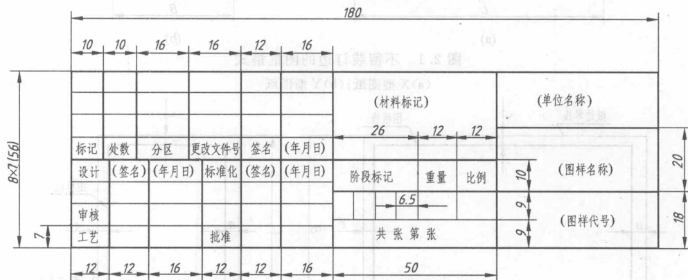
图 2.6 标题栏的格式及各部分的尺寸
