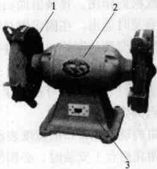
图 1—9 砂轮机 1—砂轮 2—电动机 3—机座
