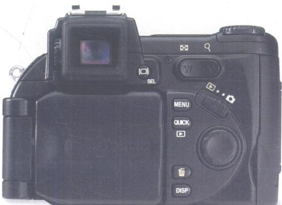
Coolpix 5700相机的背面。液晶屏幕翻盖位于取景器的下方。还可以看到缩放控制按钮。
