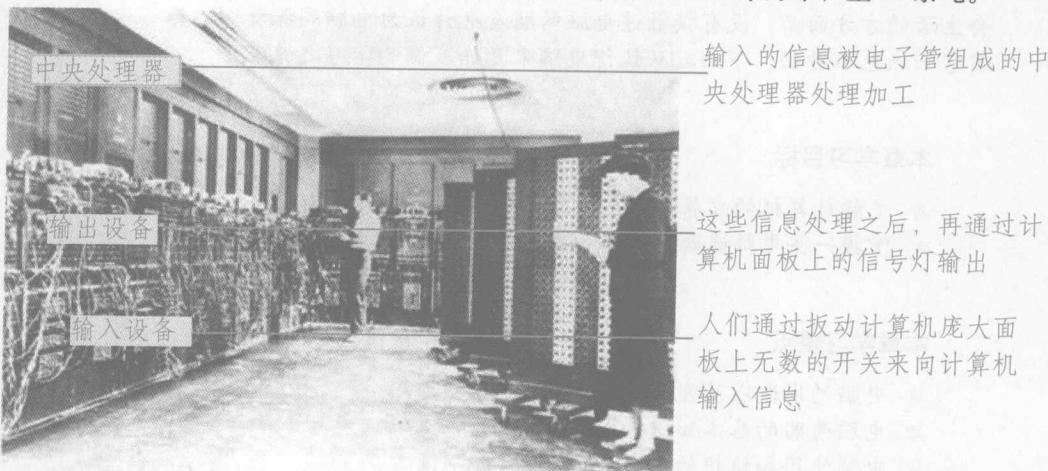
**提示** 中央处理器简称为CPU（最早的CPU是由电子管组成，现今发展到由超大规模集成电路组成），它是由运算器与控制器两部分组成的，担任着电脑的主要运算与分析工作，是电脑的核心部件。因此，CPU的性能优劣是衡量一台电脑配置高低的主要性能指标之一。
