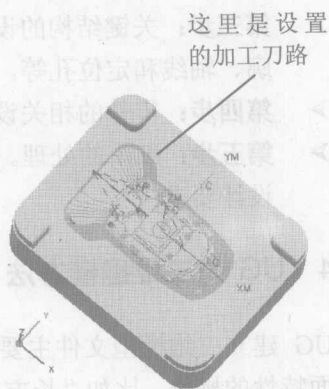
图 1-3 在 CAM 模块中设置的加工刀路
