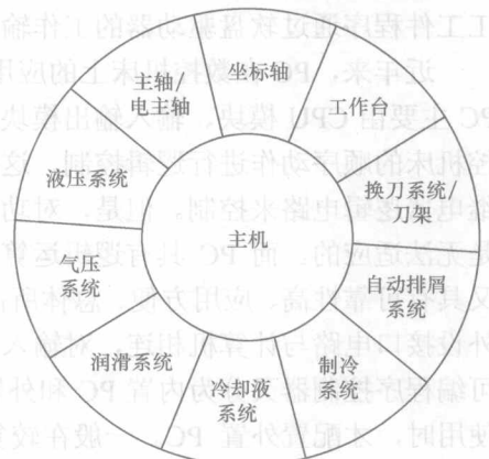
图 1.3 数控机床主机的组成框图
