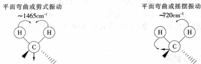
图 1-6 CH 2 的剪式和摇摆振动示意图
