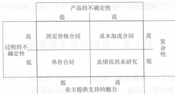
图 1-5 国际工程项目合同支付模式与项目实施过程不确定性及产品不确定性的关系
