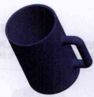
以茶杯为例，讲解排除曲面创建壳体的方法。
