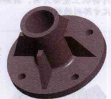
以法兰盘为例，讲解旋转肋的创建。
