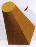
以天圆地方模型为例，讲解不同截面混合特征的创建方法。
