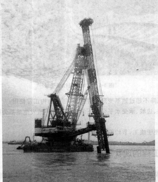
图 1-7 天威号海上打桩船
