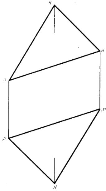
26. 在 $\triangle ABC$ 内作一条正平线和一条水平线
